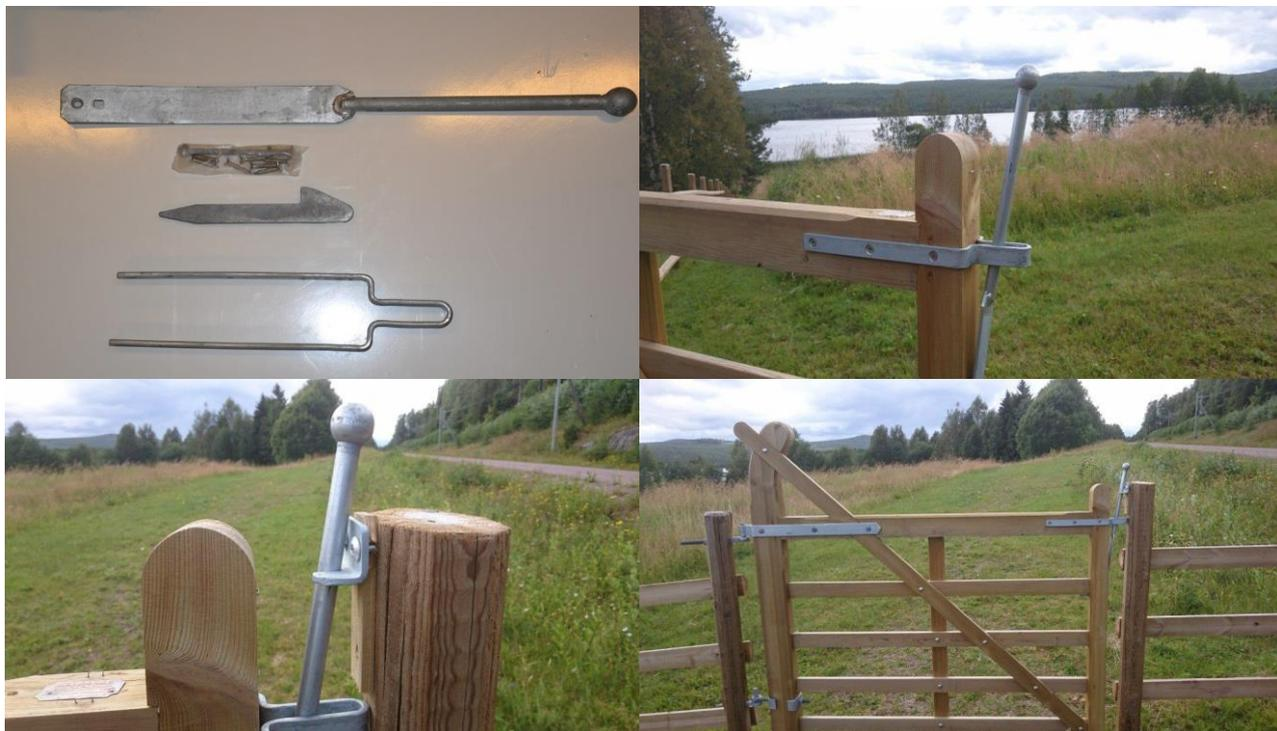
Der Bodenschieber wird wie auf der Abbildung dargestellt montiert. Bitte beachten Sie: Je höher die Bodenfreiheit des Tores ist, desto tiefer muss der Bodenschieber am Tor angebracht werden, damit der Schieber tief genug in den Boden eindringen kann. Öffnen Sie das Tor bis zur gewünschten Position und graben Sie die Bodenhülse so ein, dass sie ebenerdig abschließt und sich direkt unterhalb des Schiebers befindet.
